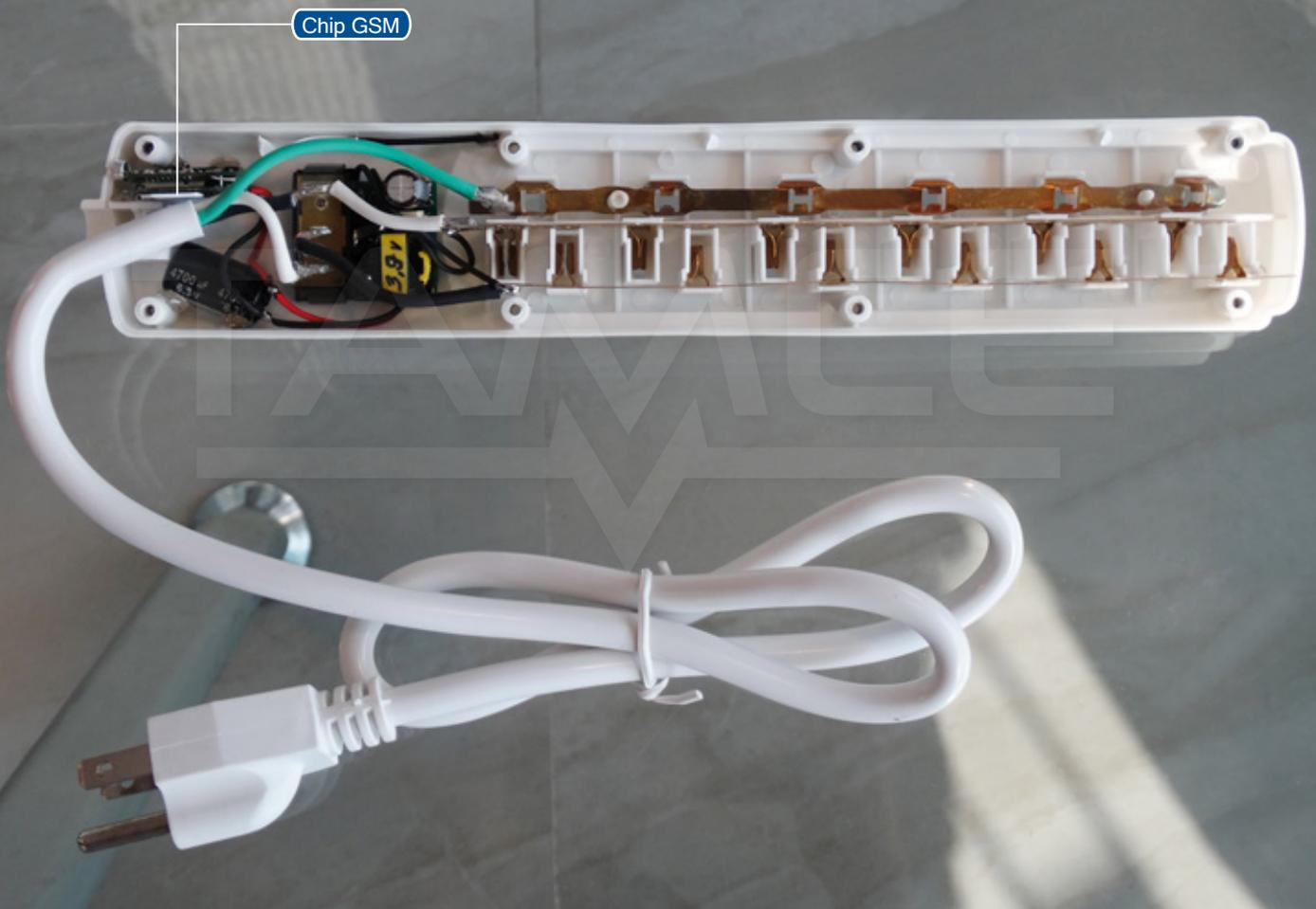
En su interior tiene un diminuto transformador de corriente alterna a DC que no genera nada de interferencia y sus 6 tomas funcionan normalmente para pasar de forma totalmente desapercibida.
