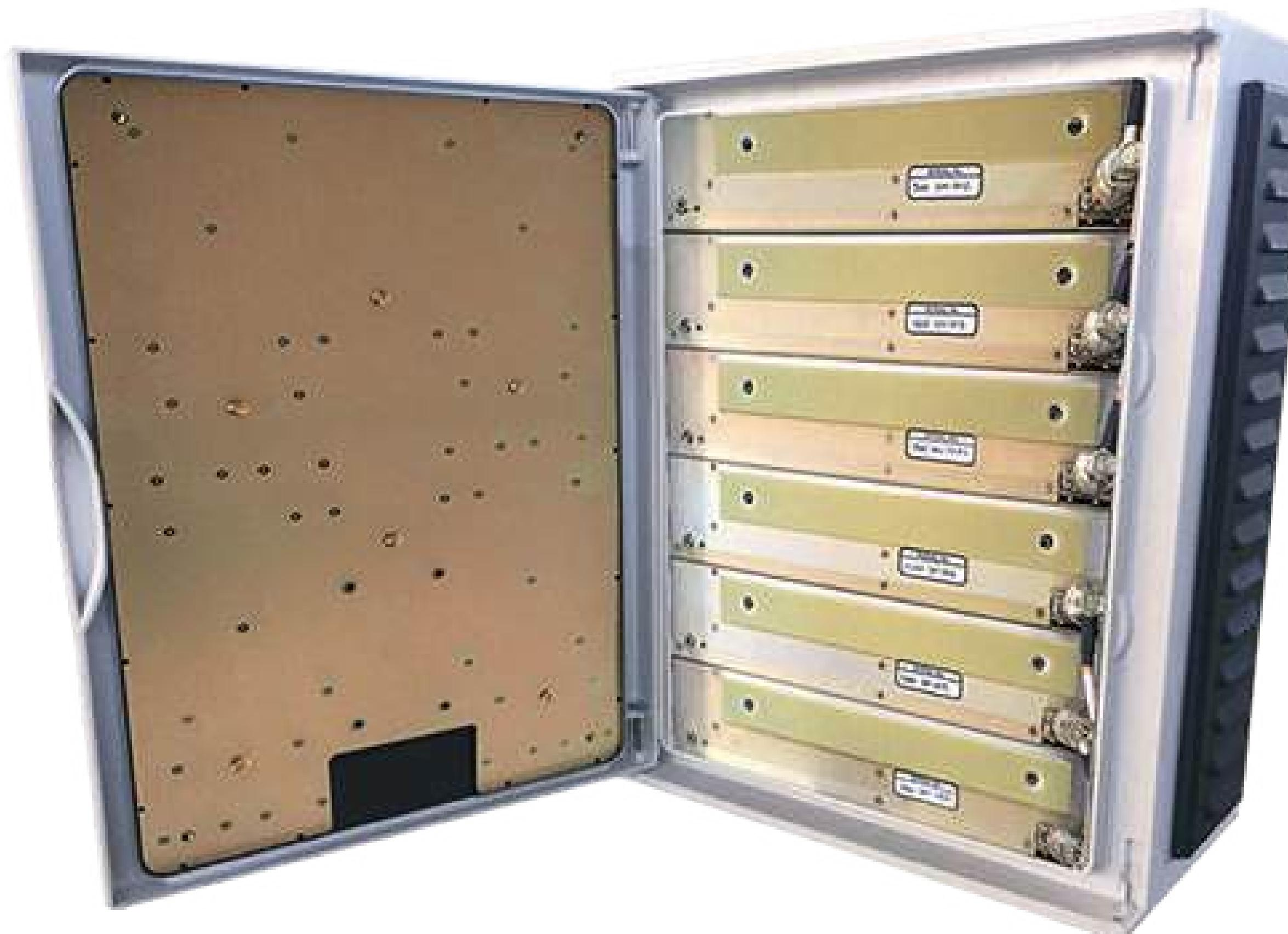
El Bloqueador para reclusorios TC-400 es un inhibidor de potencia intermedia (30 watt por banda) administrable remotamente, diseñado de manera exclusiva para ser instalado en centros penitenciarios.
